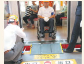
新しいスロープ板の検証
