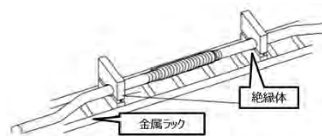
ケーブルとラックの非接触化
